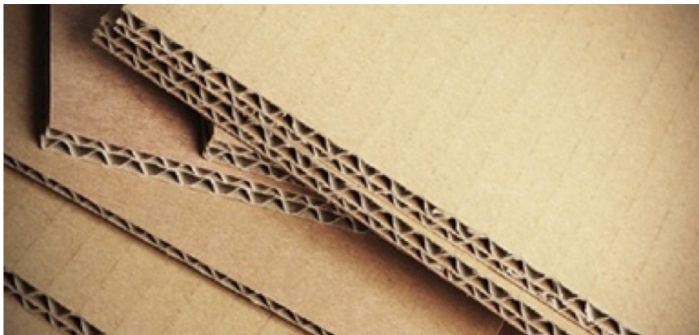
Figura 16: Chapas de Papelão Ondulado Onda Simples (B E C) e Onda Dupla (BC)
